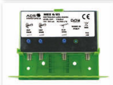
Gli Amplificatori da palo Serie ABL e Serie MBX sono caratterizzati da una gura di rumore da 2dB con basso coefficiente di intermodulazione e da un livello d'uscita di 108 dB $\mu$ V su banda VHF e 110 dB $\mu$ V su banda UHF. Sono progettati per impianti singoli con diverse utenze o piccoli impianti collettivi siti in zone con molta interferenza.
