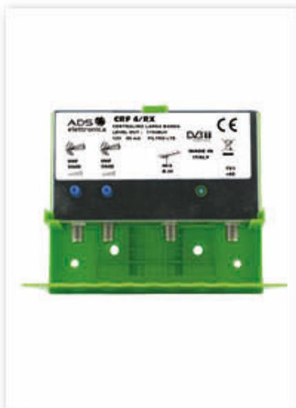
Gli Amplificatori da palo Serie CRF Interstage s attenuano l'ingresso dopo il 1° stadio di ampli cazione al ne di garantire un elevato rapporto segnale/ rumore e un livello di uscita da 600 mV.
