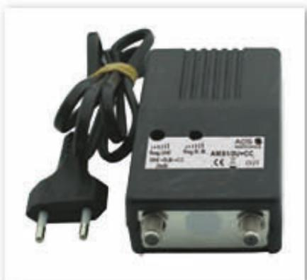
Gli amplificatori di linea serie AMS autoalimentati sono componenti attivi che incrementano il livello di segnale TV nella banda 40~800 MHz utilizzabili ove sia necessario ripristinare un'adeguato livello di segnale. E' bene sottolineare che il livello del segnale in ingresso all'amplificatore deve restare sotto i 70 dB $\mu$ V, un segnale oltre questa soglia comporta il mal funzionamento dell'impianto.
